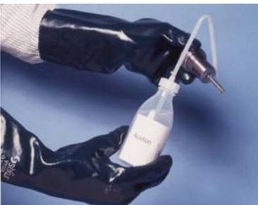
Laver ensuite à l'acétone et absorber les gouttes éventuelles avec un kleenex. Raccorder le câble à la sonde. Le Display doit afficher 0,00 ppm sur l'échelle la plus petite 0...10 ppm. Dans le cas contraire, la procédure de lavage doit être répétée.
