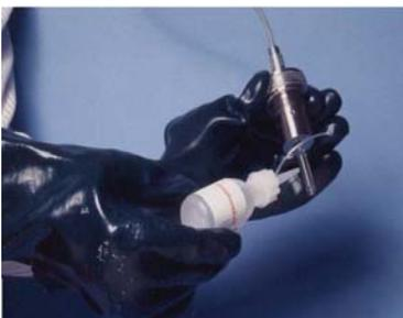
A l'aide d'une pipette, répartir régulièrement l'acide phosphorique à 50% sur le doigt de la sonde, tout en faisant tourner celle-ci. L'acide phosphorique commence à mousser et se répartit ainsi de façon optimale autour des électrodes. **L'échelle de mesure la plus grande (0-5200 ppm/v) est sélectionnée automatiquement (service).**
